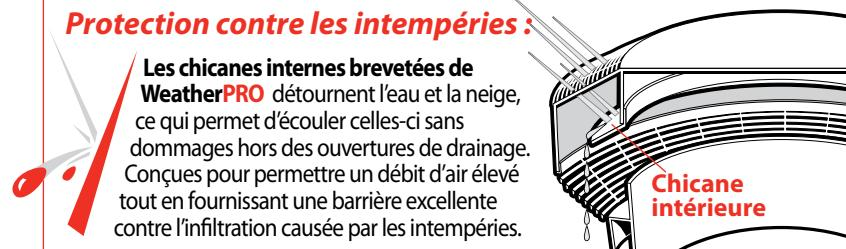
Les chicanes internes brevetées de WeatherPRO détournent l'eau et la neige, ce qui permet d'écouler celles-ci sans dommages hors des ouvertures de drainage. Conçues pour permettre un débit d'air élevé tout en fournissant une barrière excellente contre l'infiltration causée par les intempéries.
