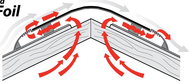
**Le rebord AirFoil PRORidge** permet l'écoulement en douceur de l'air sur le faîtage, optimisant la ventilation du grenier tout en protégeant contre les débris soufflés par le vent.
